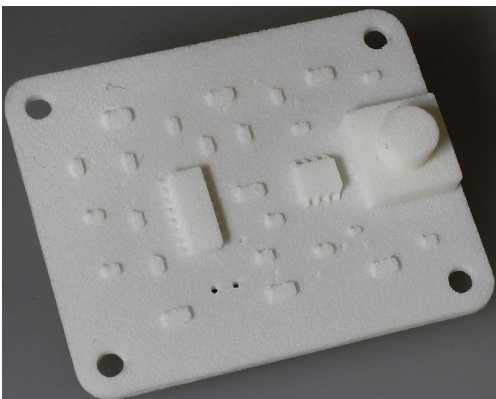
Bild 8: Ein 3D Druck Ihres Layouts. Ein 3D Klon aus gesintertem Kunststoff
